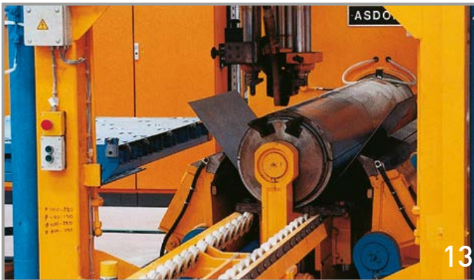
13. Ρομπότ διαμόρφωσης και συγκόλλησης κυλίνδρων για μέγιστη ακρίβεια και ποιότητα / Cylinder forming and welding machine for maximum precision and quality
