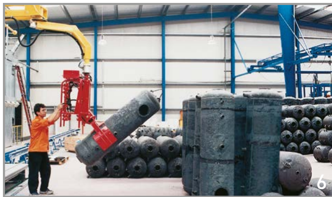
6. Μπόιλερ πριν την συναρμολόγηση / Boilers before assembly
