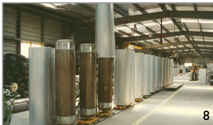
8. Συναρμολόγηση δοχείων / Assembly of storage tanks
