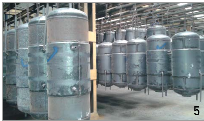
5. Μπόιλερ πριν την συναρμολόγηση / Boilers before assembly
